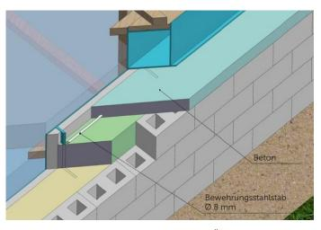
vollständig ausgefüllt sein – diese Betonschicht gewährleistet die Stabilität der Überlaufrinne. Wir empfehlen, das Betonieren erst fortzusetzen, nachdem die Betonschicht unter der Rinne angezogen ist. Stellen Sie beim Betonieren sicher, dass das Zuleitungskabel und die Lichtanschlussdose nicht einbetoniert werden.
